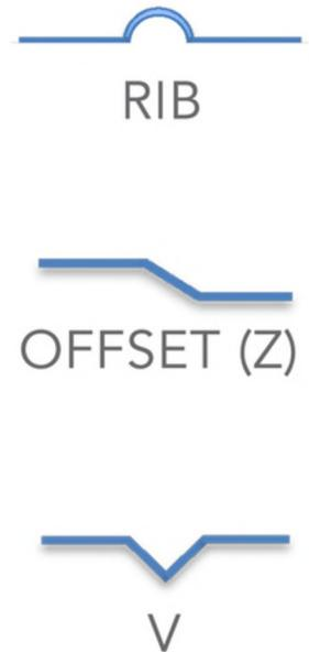
La serie GA ROLL prevede tre tipologie principali di deformazioni standard: RIB, V e Z con valori a catalogo predefiniti.
