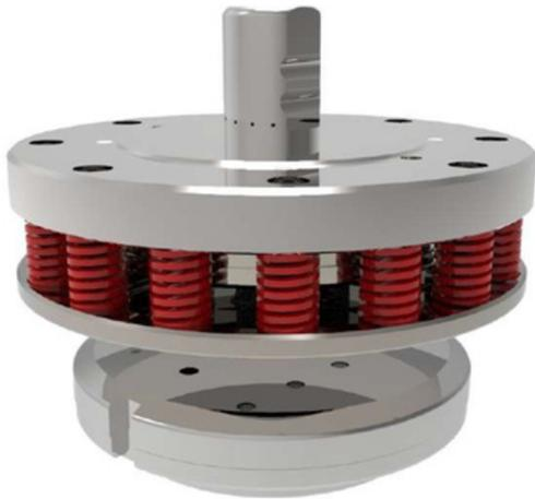
Multiplo su Flangia 200 per esecuzione di n° 6 fori diam. 6 mm ad interasse largo. Sistema di estrazione a molle e tasselli intercambiabili
